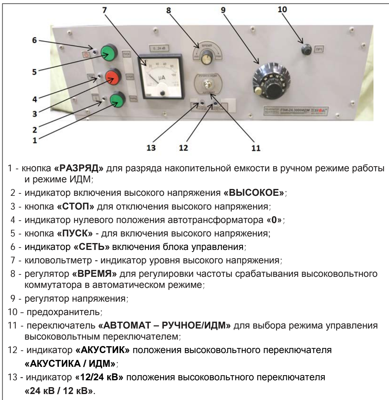
Рисунок 2 Блок управления и индикации генератора
