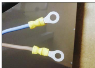
Рисунок 7 Наконечники кабеля питания
