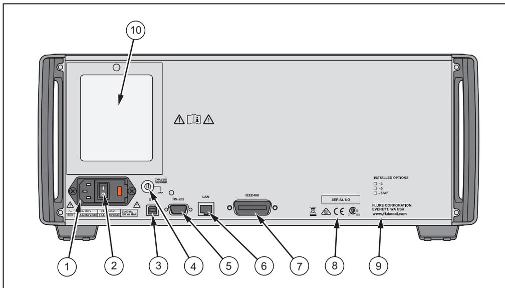
Рис. 3-2. Задняя панель
