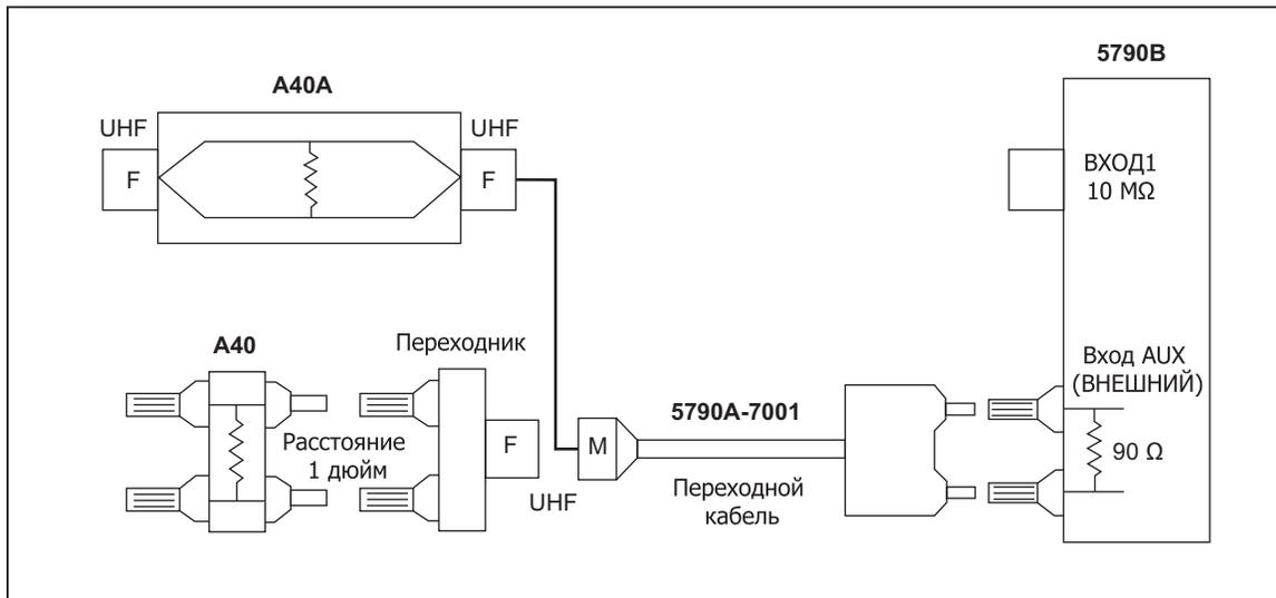
**Рисунок 4-5. Измерения относительного тока с использованием 5790A-7001**
