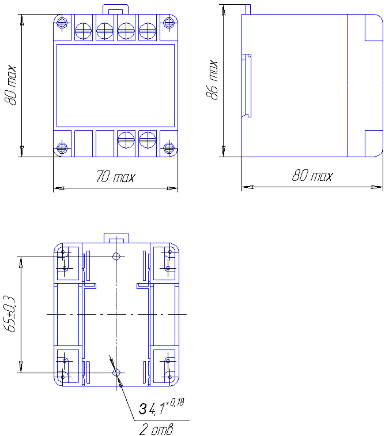
Рисунок А.2 – Габаритные и установочные размеры преобразователей Е856ЭЛ,
