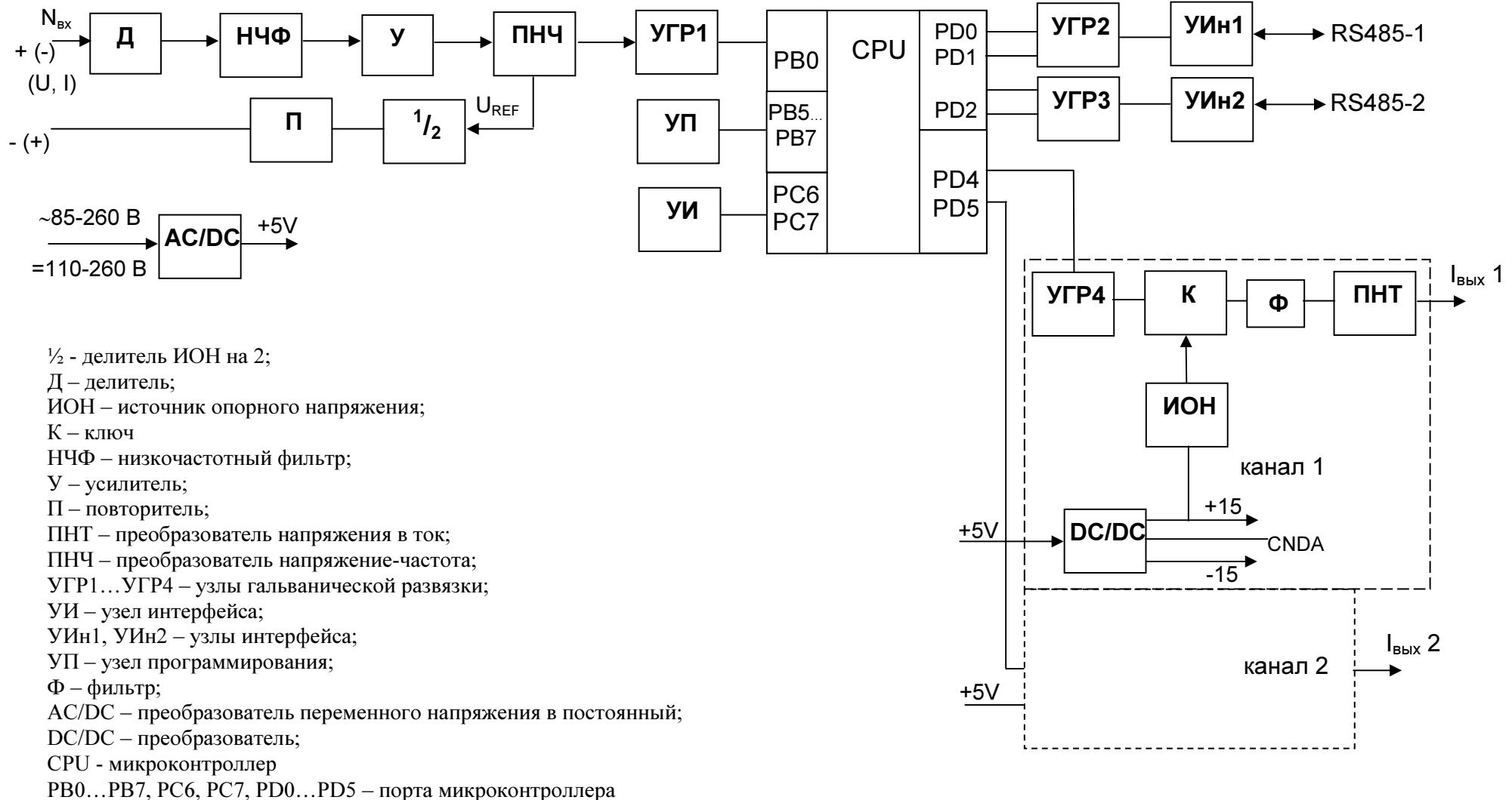
Рисунок Б.1 – Структурная схема преобразователя Е856ЭЛ,
