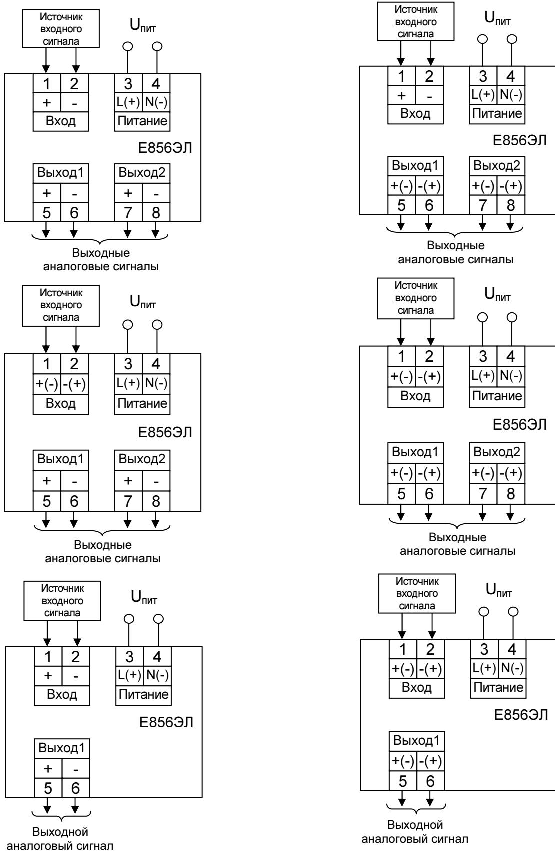
Рисунок В.2 – Схемы подключения преобразователя Е856ЭЛ,
