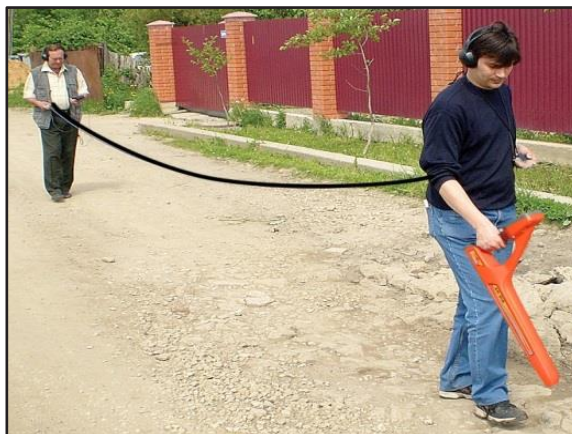
Рисунок В.4 Определение дефектов изоляции при помощи ДОДК-117.
