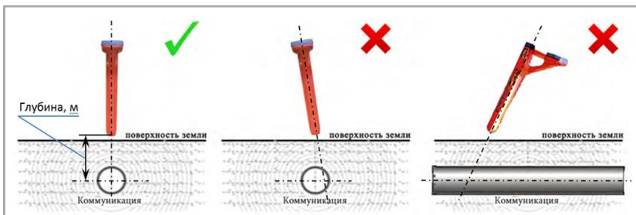
Рисунок 3.6. Правильное положение приемника при замере глубины.
