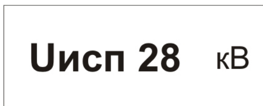
Рис.5 Установка значения испытательного напряжения
