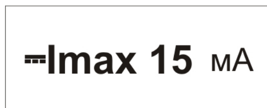
Рис.6 Установка значения тока отсечки
