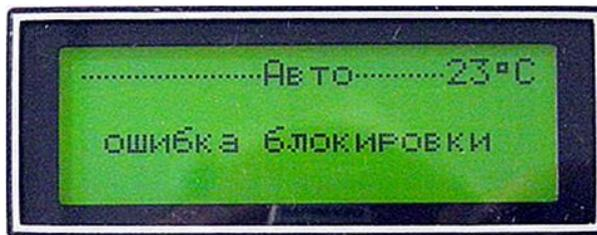
Рисунок 11. Вид экрана при открытой крышке термостата.
