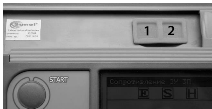
Расположение разъемов зарядки (1) и подключение компьютера USB (2)
