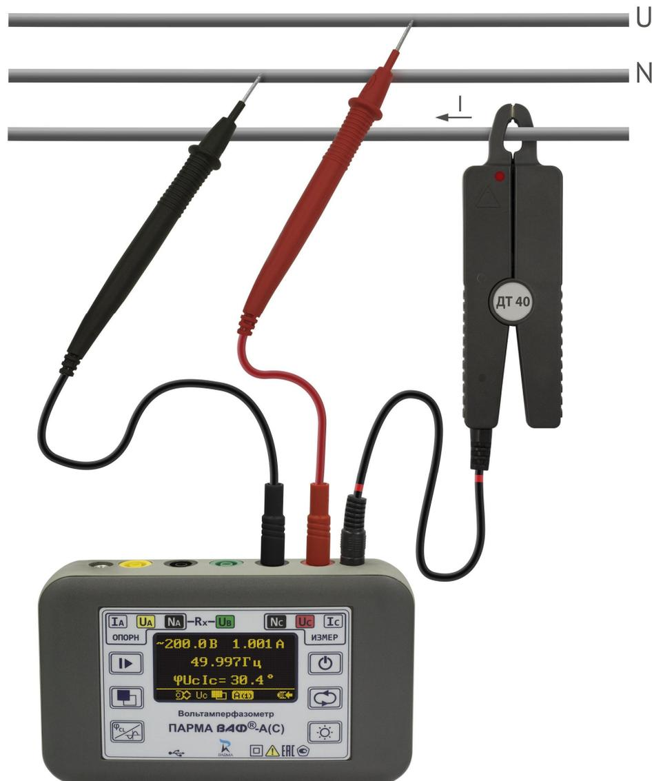
Рисунок 14 Схема подключения для измерения мощности
