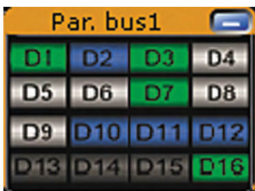
Состояние сигналов цифровых каналов отображается на пиктограммах сигналов вне зависимости от настроек осциллографа
