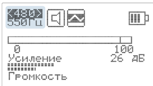
Рисунок 7 – Отображение выбранной частоты в основном экране
