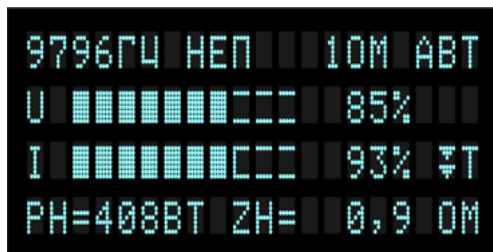
Рисунок 6.4 – режим ограничения по температуре (▼Т)
