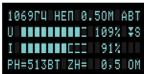
Рисунок 6.2 – режим ограничения по мощности ( \nabla S)
