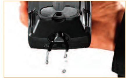
Удобное считывание данных измерений с подсвечиваемого дисплея. Ресурс аккумуляторной батареи составляет 10 часов. Прибор превосходно подходит для эксплуатации в "суровых" условиях. Опорожнение конденсатосборника осуществляется быстро и просто.
