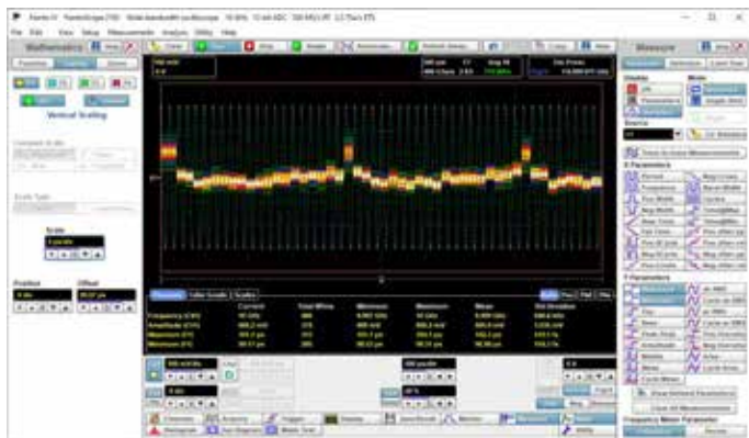
Рис. 32 Тренд периода, измерение нелинейности временной развертки осциллографа с сигналом синусоидальной формы с частотой 10 ГГц (период 100 пс). Максимальный тренд периода = 102,3 пс. Минимальный тренд периода = 98,98 пс
