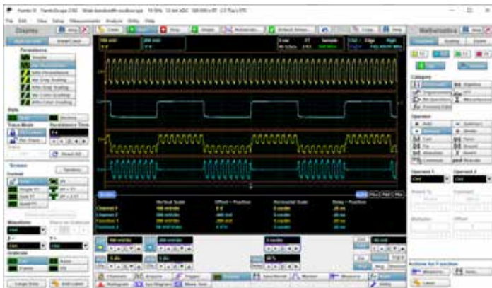
Рис. 29 Пример арифметических функций (сверху вниз): а) канал 1, б) канал 2, в) сумма, канал 1 + канал 2, г) умножение канал 1 x канал 2
