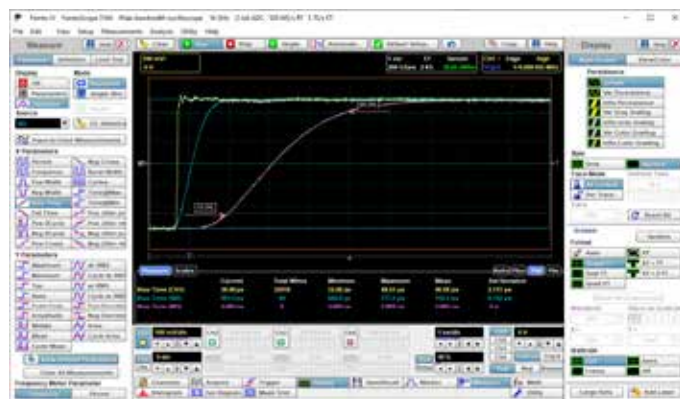
Рис. 6 Сравнение переходных характеристик на осциллографе АКІП-4133/4А сделанных для двух разных полос пропускания. Левая осциллограмма отклик показывает время нарастания 35 пс, полученное в режиме полной полосы пропускания (16 ГГц), а правая осциллограмма показывает время нарастания 721 пс, полученное в режиме узкой полосы частот 450 МГц. Время нарастания сигнала на входе 25 пс.
