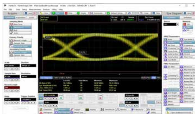
Рис. 7 Глазковая диаграмма 16 Гбит/с на осциллографе АКІП-4139/2
